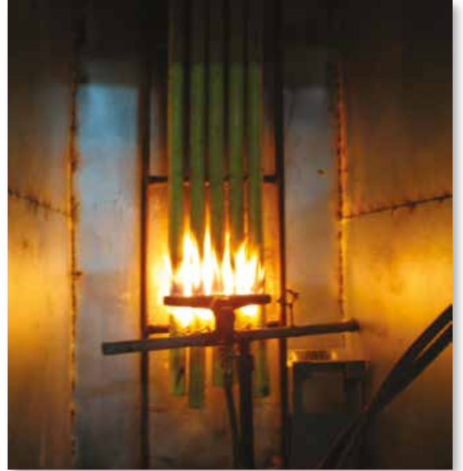
Demetlenmiş kabloların yanması testindeki bir kablo numunesi.
