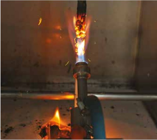
Yanan damlacık testindeki olumsuz bir kablo numunesi.
