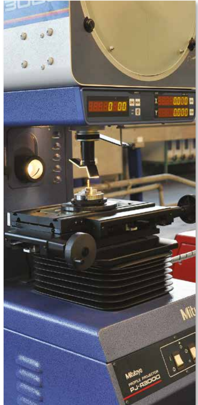
Profil projektör ile geometrik ölçümler yapılır.
