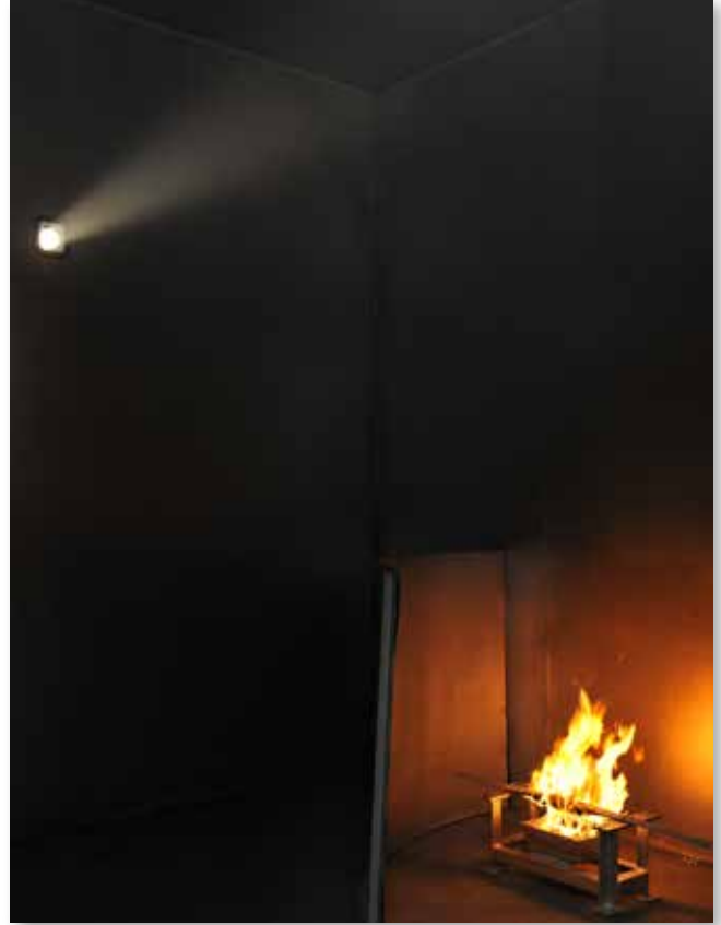
Duman yoğunluğu testindeki bir kablo numunesi.
