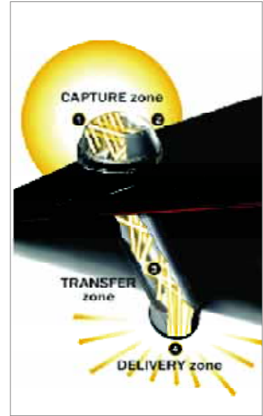
Şekil 3 - Çatıya monte güneş borusu Figure 3 - A roof mounted solar tube
